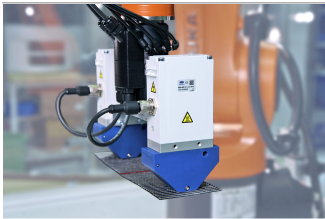
Игольчатые захваты SNGi-AE, используемые для перемещения композитного текстиля
